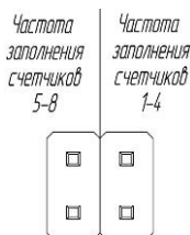
Рисунок 2.4 - Назначение выводов разъемов "Частота"
