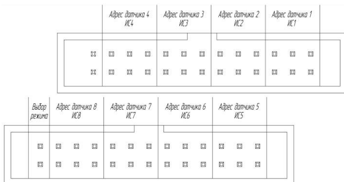
Рисунок 2.3 - Назначение выводов разъемов "Адреса"
